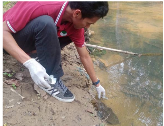
ภาพที่ 3.5.4-1 การเก็บตัวอย่างน้ำผิวดิน
